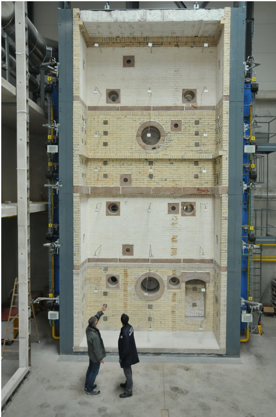
Abbildung 1: Der Prüfofen mit einer Höhe von 9 m und einer Breite von 4 m wird dazu verwendet um besonders große Bauprodukte bezüglich ihrer Feuerwiderstandsfähigkeit zu testen. Dazu wird das jeweilige Produkt (z.B. eine Verglasung, eine Wand, ein Tor, ...) an der
